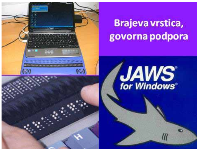
Slika 5: Običajen računalnik z brajevo vrstico in program Jaws – sintetizator zvoka
