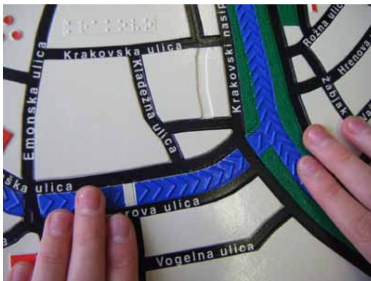
Slika 6: Tipni zemljevid Ljubljane. Ulice so poglobljene, reke in zelene površine imajo različno teksturo, nekaj je napisov v brajici. Uporabljene so močne barve za slepe z ostankom vida. (Izdelava zemljevida Geodetski inštitut Slovenije.)
